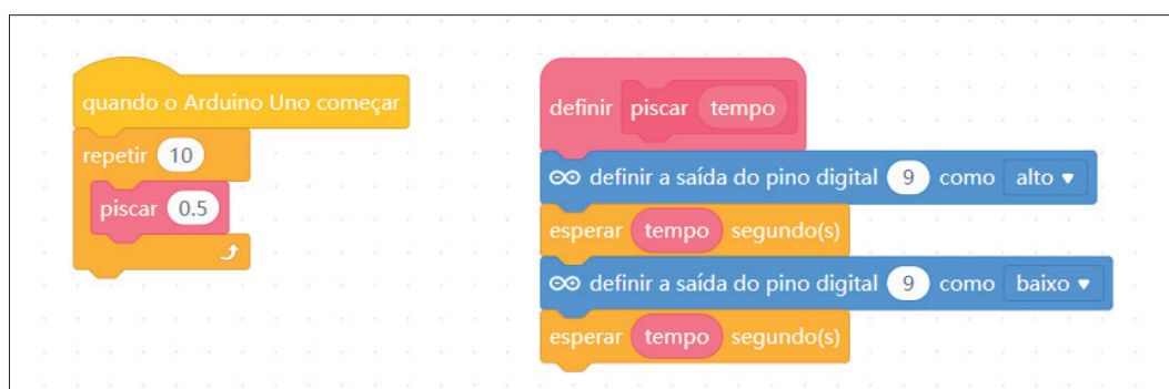
Figura 22 - Utilizando o bloco na programação
