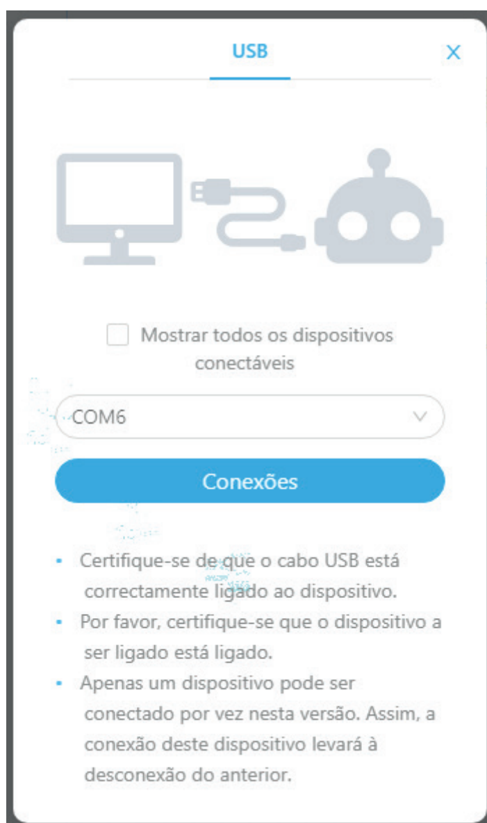
Figura 26 - Confirmar conexão entre mBlock e Arduino Uno
