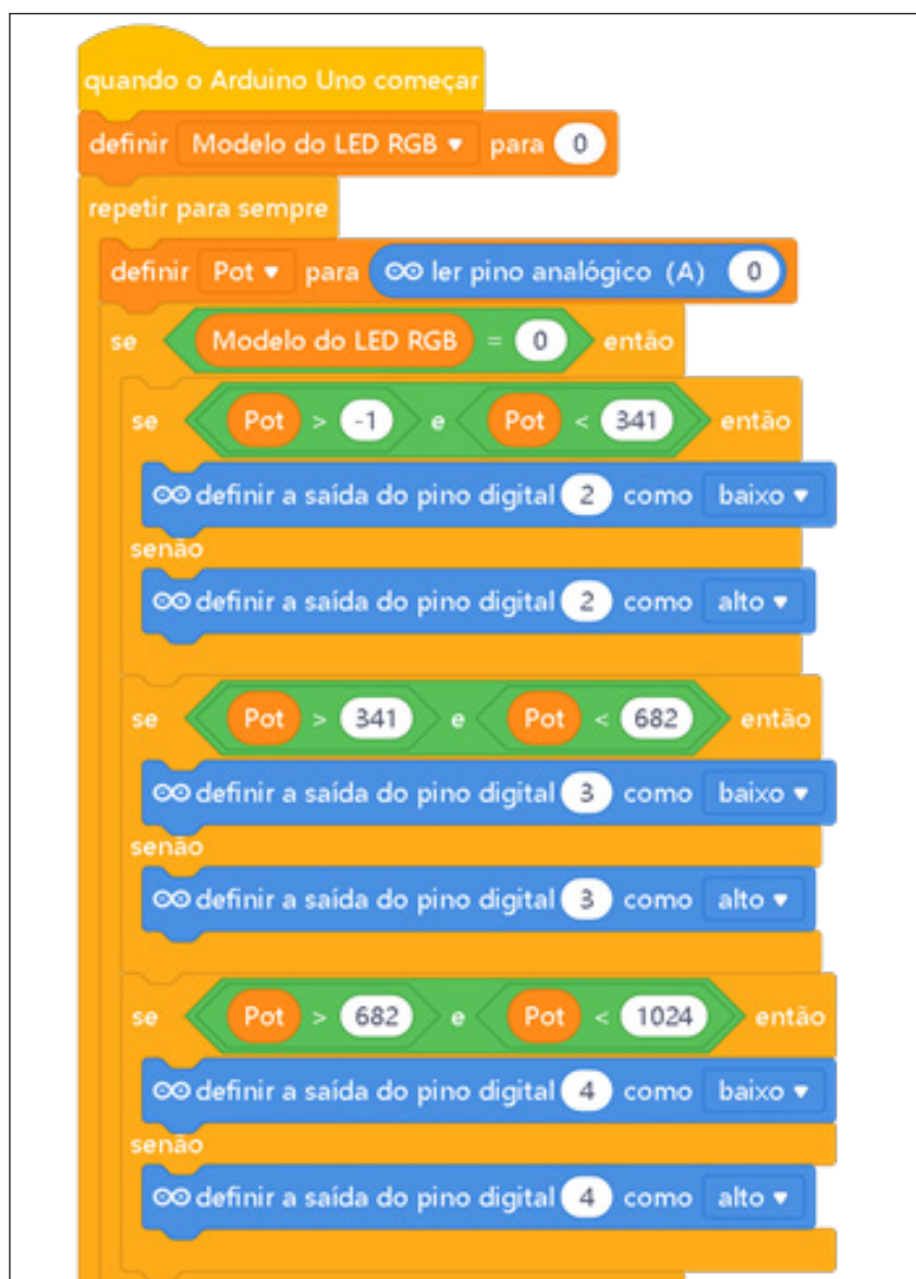
Figura 11 - Programação em blocos para controle do LED RGB
