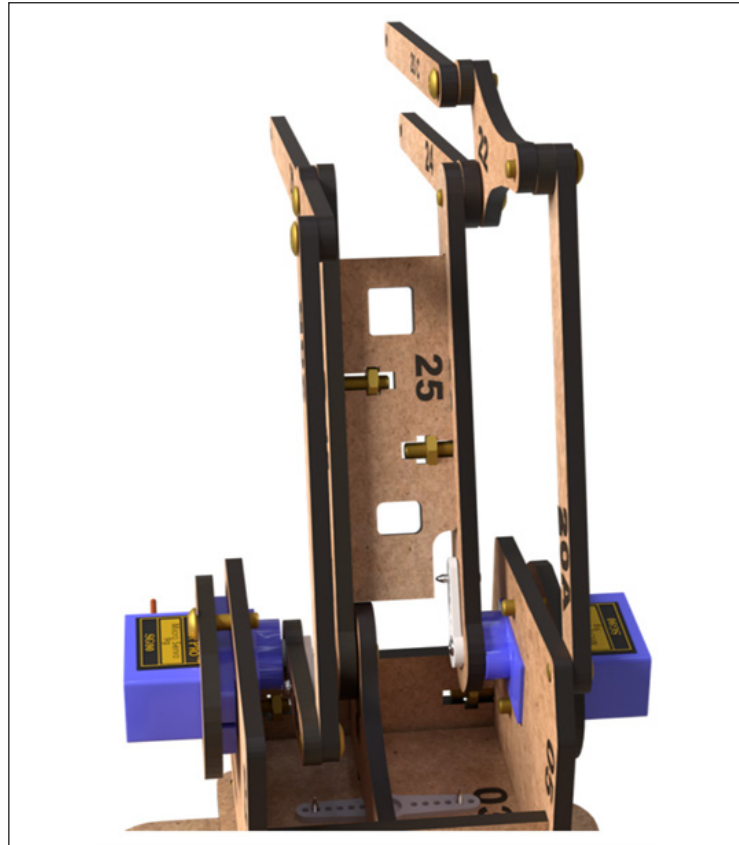
Figura 21 - Montagem do Braço Robótico sem a garra
