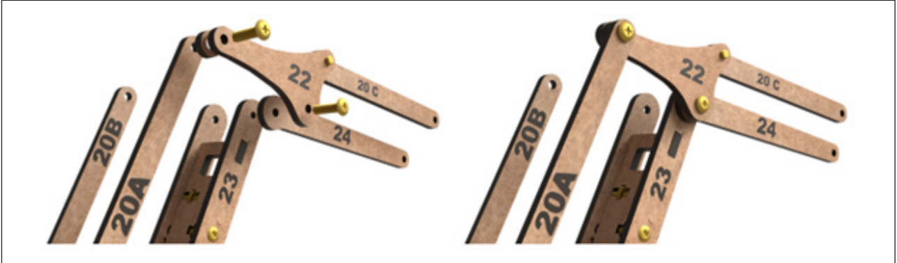
Figura 18 - Montagem das peças 24 e 22
