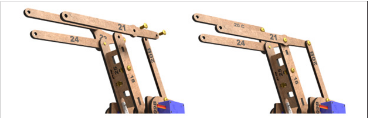
Figura 20 - Montagem do lado esquerdo do Braço Robótico
