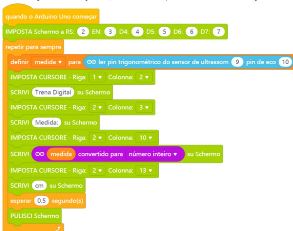
Assim que os blocos estiverem montados, clique no botão Conectar para iniciar a comunicação entre o software mBlock com a placa de Arduino Uno. Ao clicar sobre o botão **Conectar**, aparecerá um *Tooltip* solicitando a confirmação da conexão entre os dois dispositivos.
