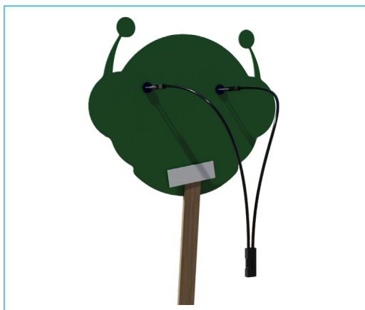
Figura 07 - Conexão dos jumpers fêmea-fêmea aos polos negativos do LED
