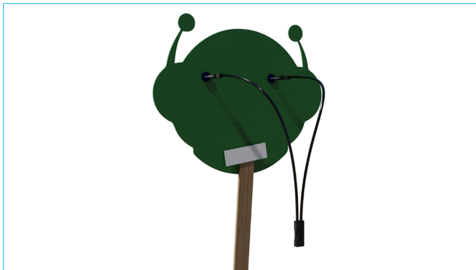
Figura 06 - Conexão dos jumpers fêmea-fêmea aos polos negativos do LED
