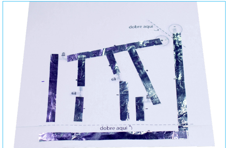
Figura 12 - Colagem da fita condutora alumínio
