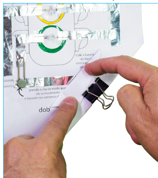
Figura 07 - Fixando a Bateria com Mini Binder Clip
