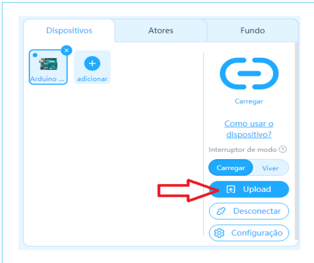
Figura 8 - Upload da programação do mBlock ao Arduino Uno
