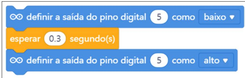
Após o efeito de pisca percorrendo cada coluna, adicionaremos um delay (tempo) de 3 milissegundos e desligaremos todos os LEDs também por 3 milissegundos. Ao carregar o código ao Arduino, o efeito da iluminação cênica definido em nossa programação se repetirá por ter sido criado todo dentro da chave **<repetir para sempre>**.
