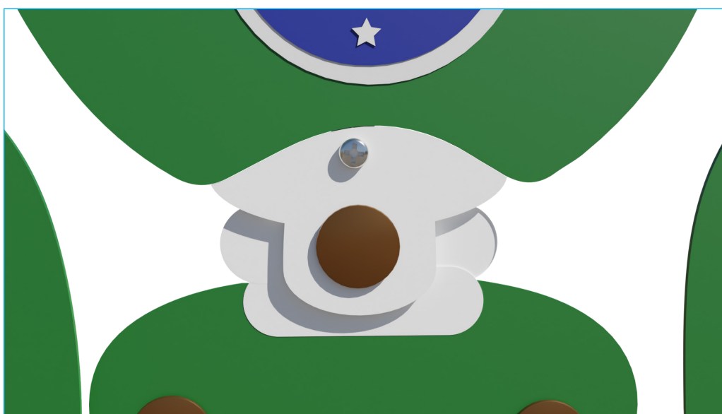
Figura 11 - Fixando com parafuso a pazinha simples do servomotor no tronco do BIT (detalhe frente)
