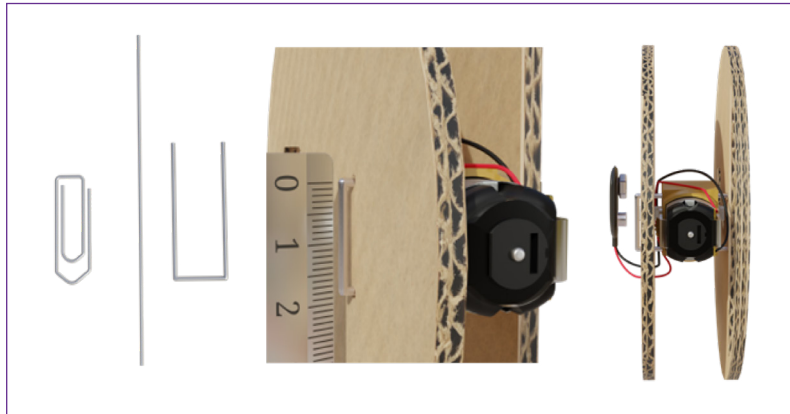
Figura 3 - Marcando os furos para colocar o clipe
