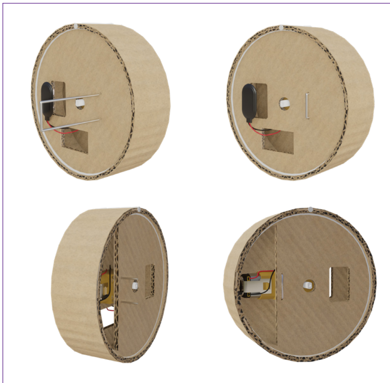
Figura 4 - Prendendo o motor de redução com o clipe
