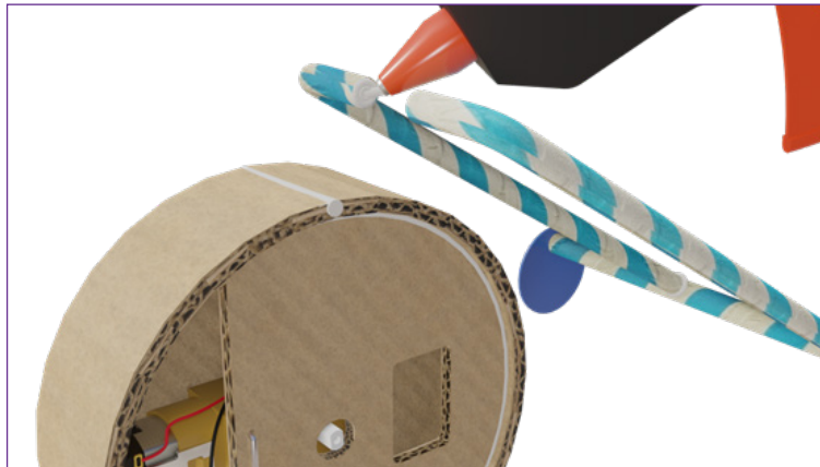
Figura 5 - Colando o eixo angular no motor de redução
