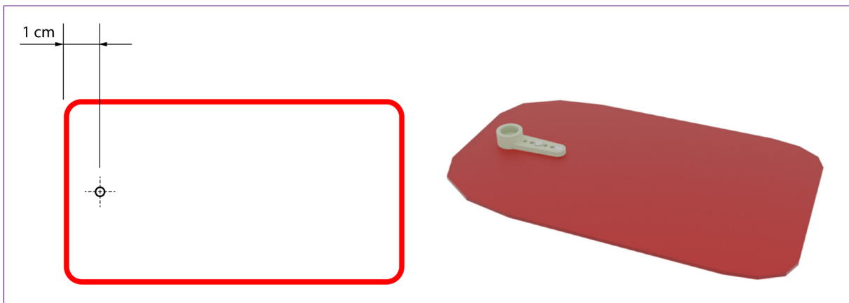
Figura 7 - Parafusando o braço do servomotor
