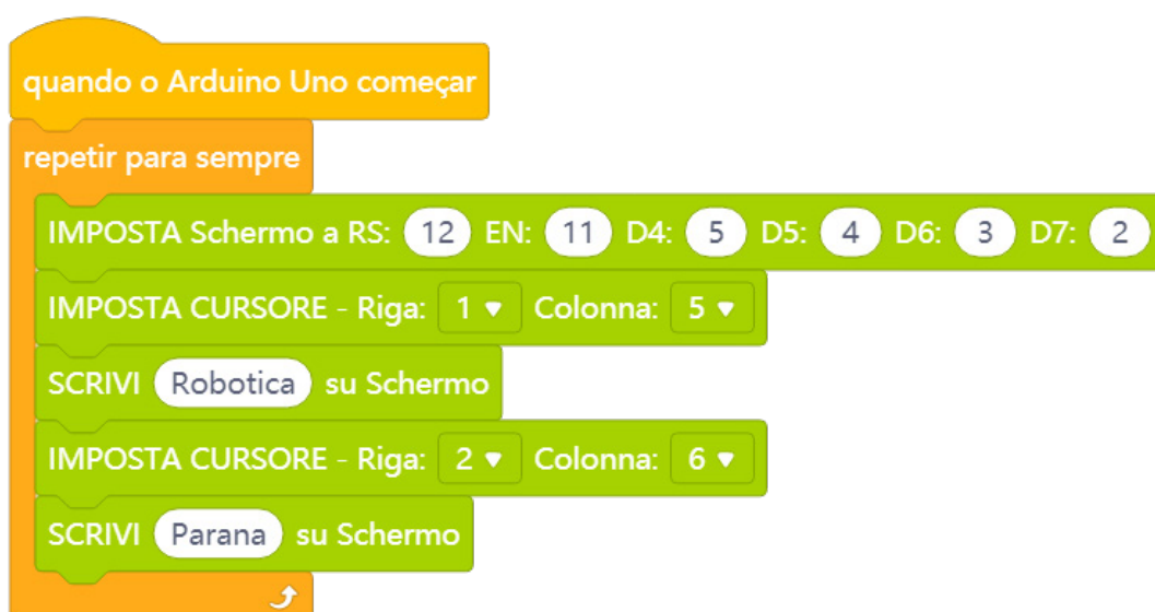
Figura 8 - Programação em blocos para leitura no Display LCD 16x2
