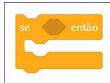
Na sequência, insira qual é a condicional, agora será preciso ativar um sensor. Entre em <SENSORES>, arraste o sensor <a tocar na cor \_\_\_?>, escolha a cor de acordo com o que foi feito o labirinto, neste caso, cor preta.
