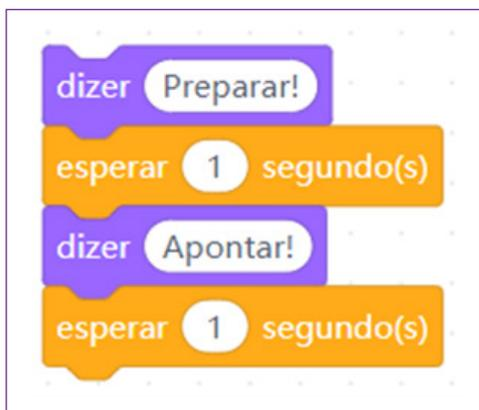
Agora, para a terceira fala entre em <APARÊNCIA>, arraste o bloco com o dizer e a marcação de tempo <dizer\_\_\_\_\_durante\_\_\_\_\_segundos>, na sequência insira o bloco normal de tempo como você fez nos anteriores.
