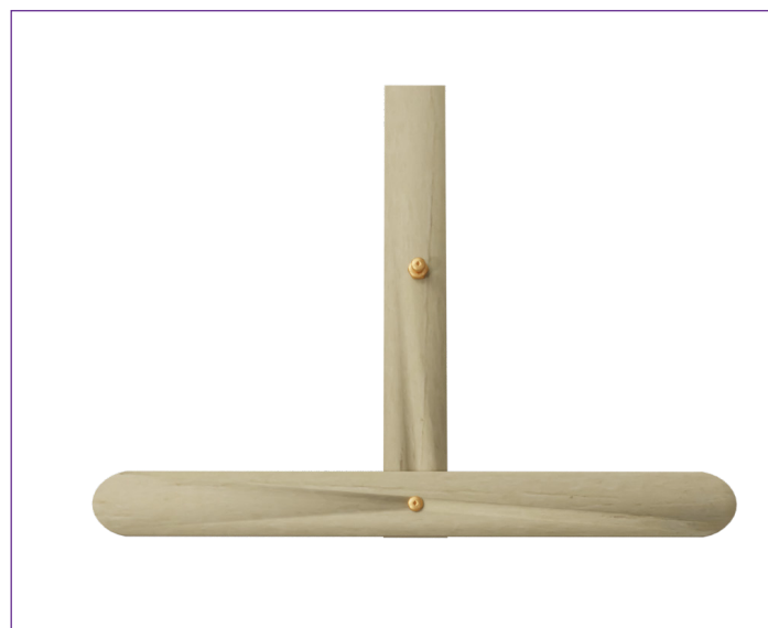
Figura 8 - Alavanca da catapulta com adição do parafuso elevado à alavanca
