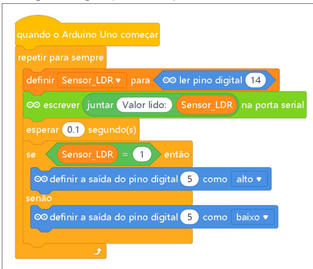
Figura 4 - Programação em blocos para controle do sensor LDR
