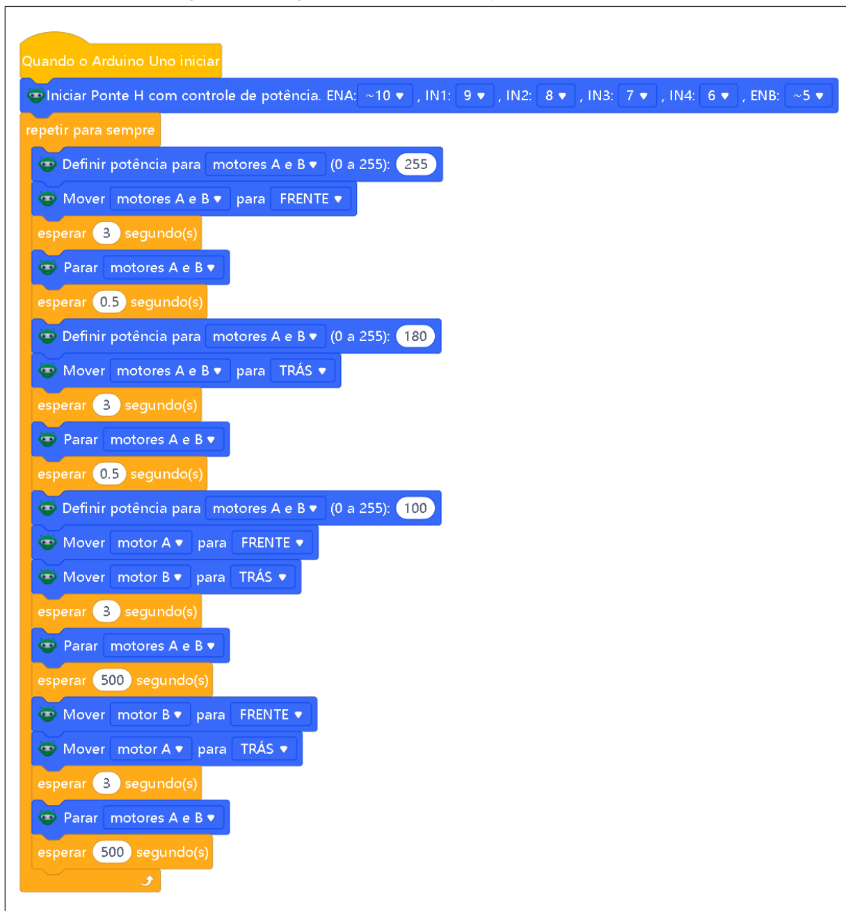
Figura 5 - Programação em blocos para controle do robô
