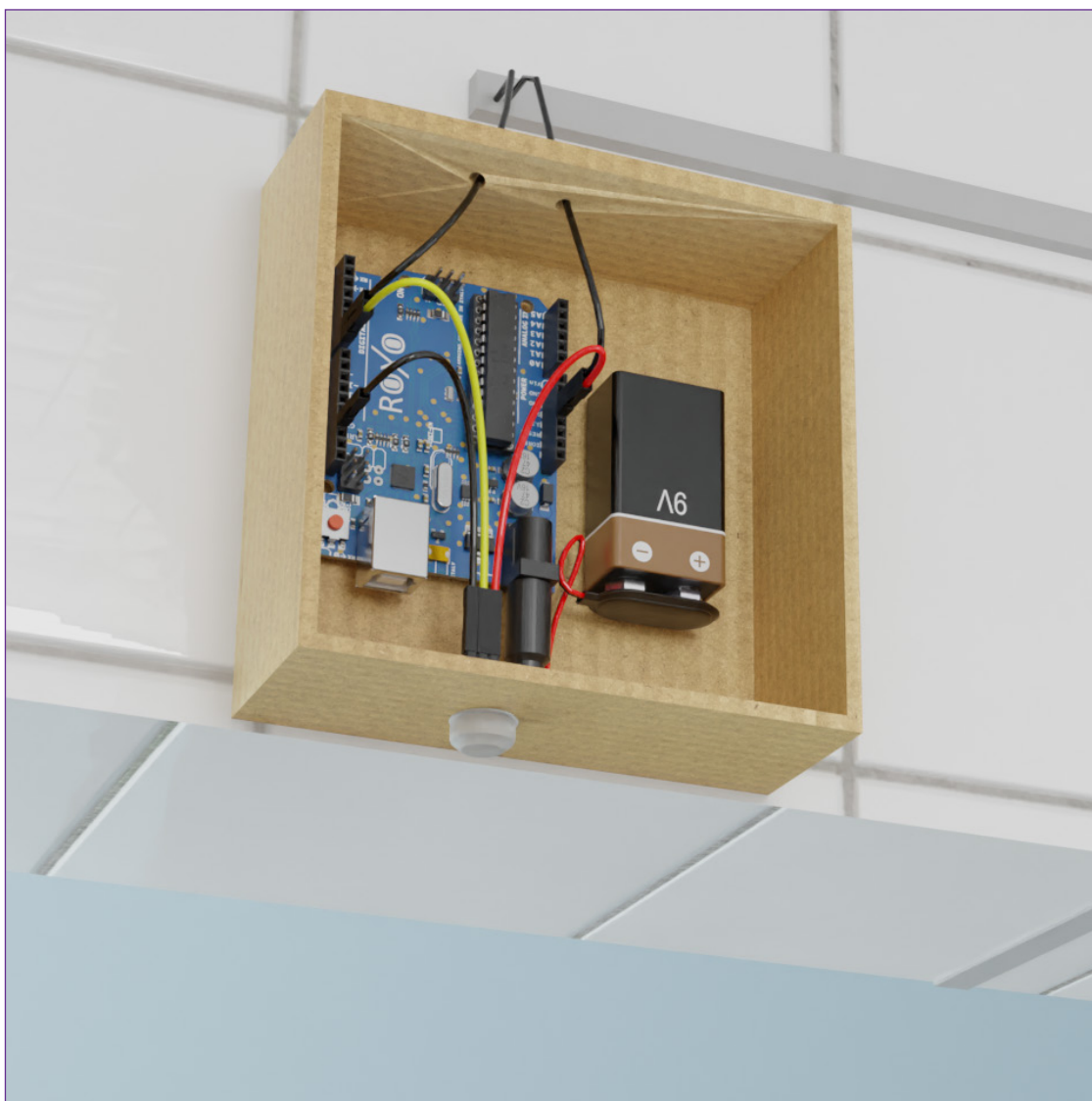
Figura 3 - Caixa com Arduino e minimódulo sensor de movimento PIR.
