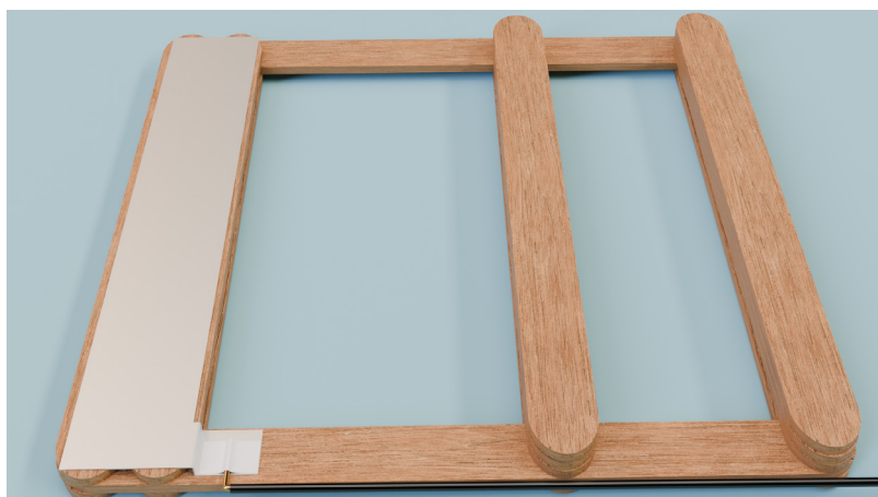
Figura 10 – Teclado com papel alumínio e fio conectado.
