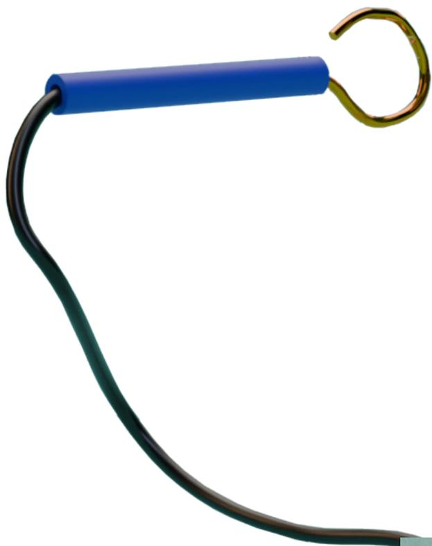
Faça a haste de contato conforme a ilustração. Encaixe na bandeja, engatando-a no polo positivo do LED.
