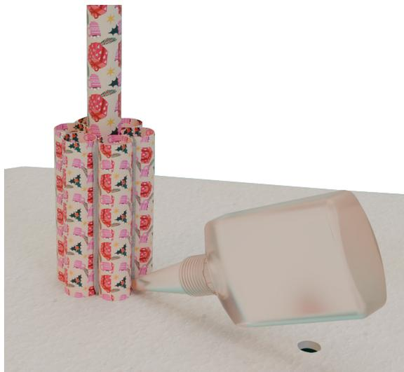
Cole a estrutura na bandeja de isopor, encaixando em seguida o LED.
