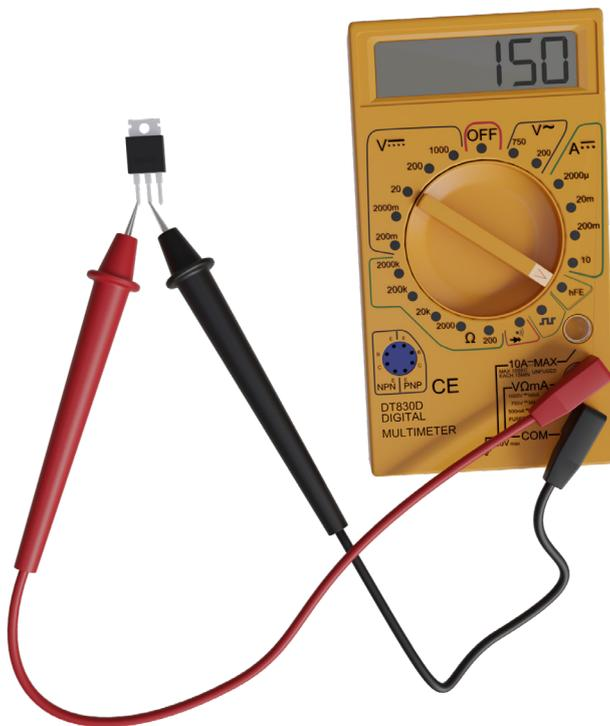
Para medir o **hFE** de um transistor com um multímetro, selecione a função de teste hFE e certifique-se de que o transistor esteja **desconectado** de qualquer circuito. Identifique os terminais do transistor e conecte a ponta de prova negativa do multímetro ao terminal do emissor (E) e a ponta de prova positiva ao terminal da base (B).
