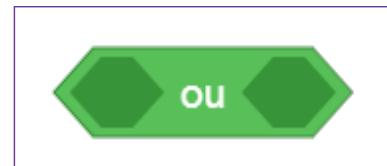
O que é preciso informar ao Arduino, é que algo acontecerá caso ele ultrapasse os intervalos de -30 e +30 no giro do eixo X. Então, para isso, você precisará acoplar o bloco do ângulo do eixo X -30 (Figura 25) dentro do primeiro espaço do bloco ou, e o bloco com a informação do eixo X +30 (Figura 26), no segundo espaço (figura 28).
