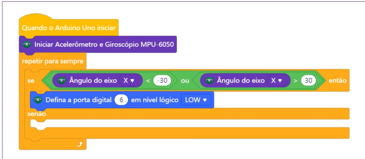
Caso, quem estiver segurando o módulo acelerômetro e giroscópio movimento para uma posição além da programada no eixo X, este LED deverá acender, indicando que saiu da posição planejada. Para isso, duplique o último bloco, o <defina a porta digital ... em nível lógico > e altere o nível lógico para HIGH.
