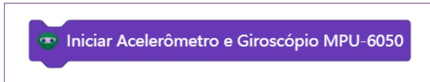
Esse bloco configura o módulo Acelerômetro e Giroscópio MPU6050, preparando para a personalização dos eixos que iremos iniciar. Antes de começar a definir ângulos para o protótipo, chamaremos para a programação o bloco <repetir para sempre>, presente na categoria Controle.
