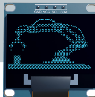
Imagem impressa no display OLED com profundidade de 1 bit
