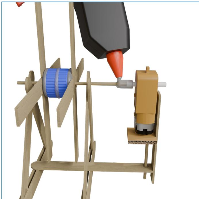
Figura 11b - Conexão entre eixo e base.
