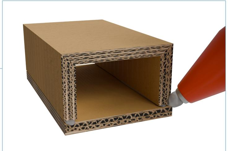
Figura 15 – Colando a base do retângulo na estrutura do braço
