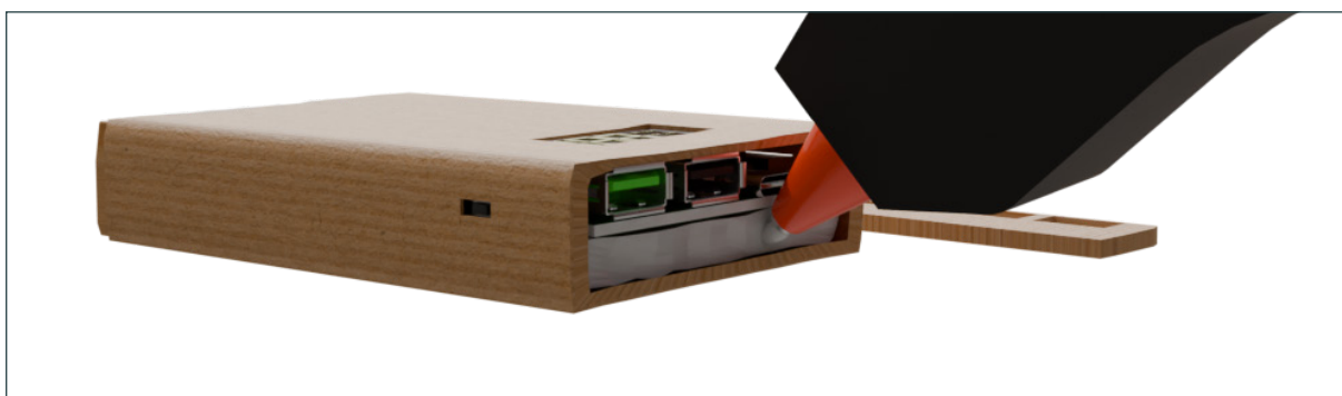
Figura 24 – Posicionando a placa e baterias no case
