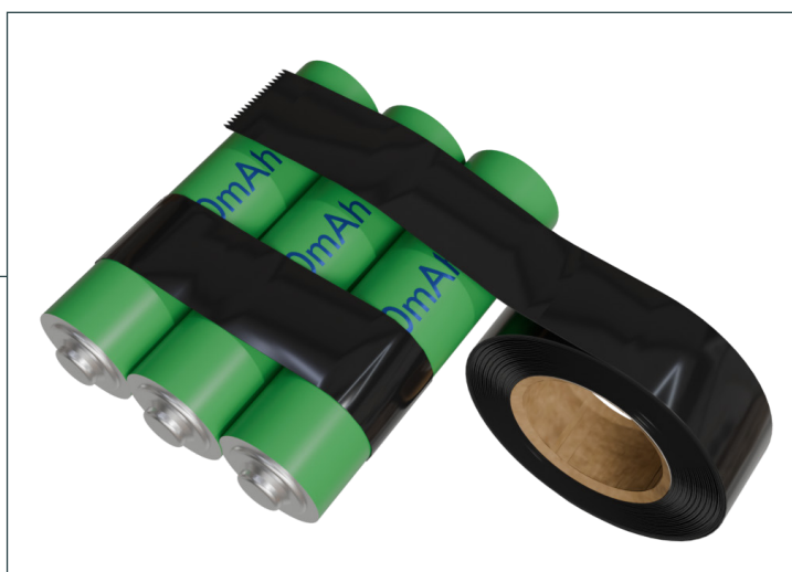
Figura 15 – Envolvendo a pilha com fita isolante
