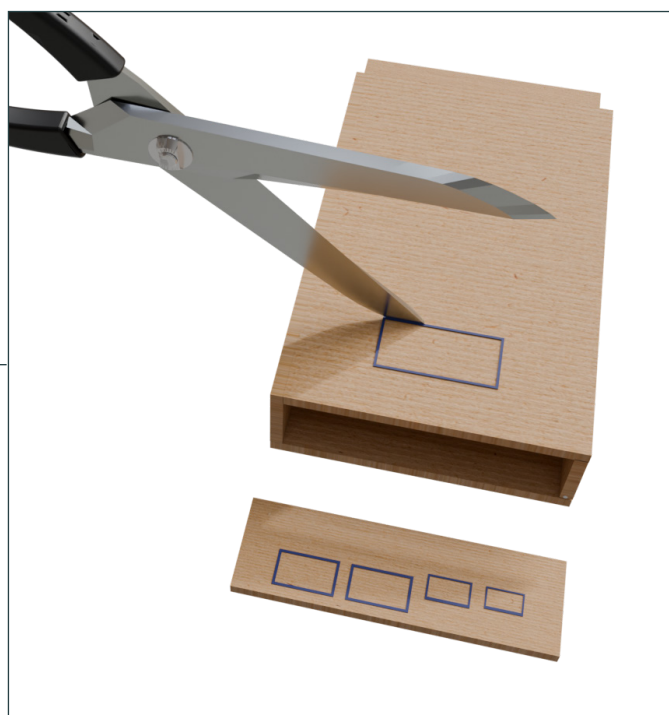
Figura 13 – Cortando o espaço para o visor
