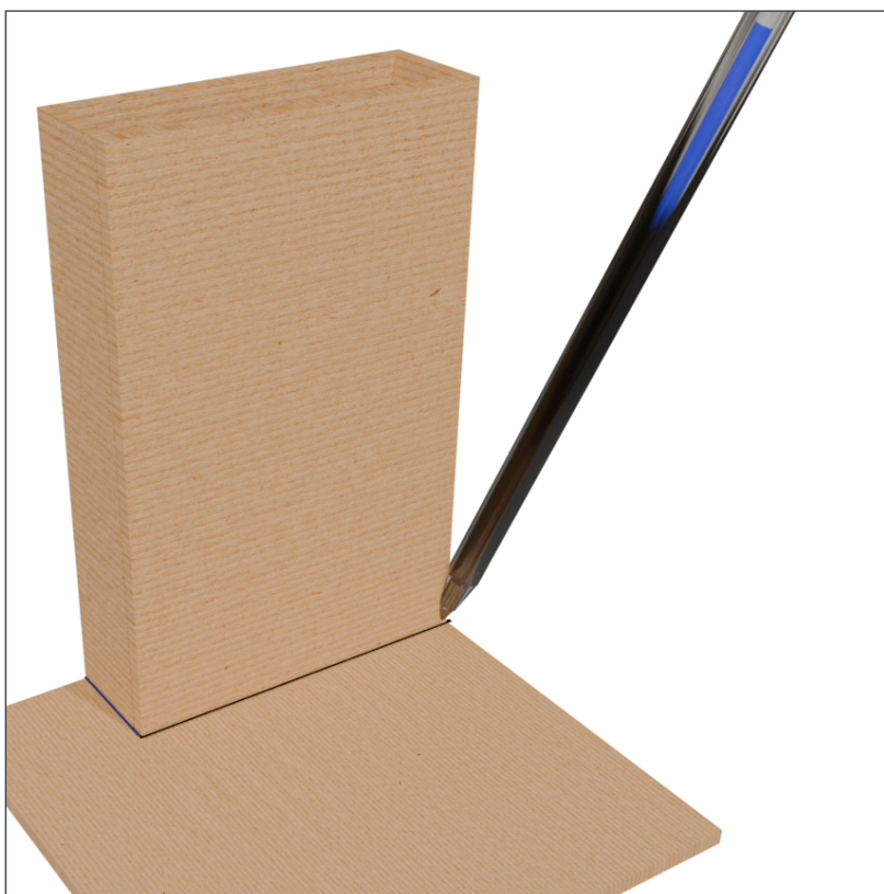
Figura 9 – Marcando o papelão para corte da tampa
