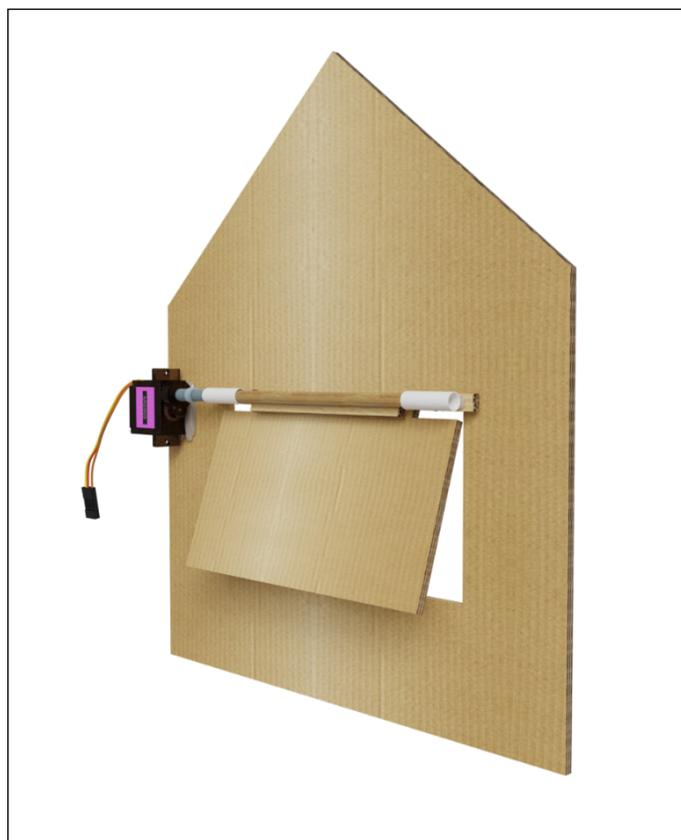
Usando cola quente, cole a base e as laterais de apoio para o protótipo, de forma que ele fique firme e não caia com o peso de abrir e fechar a janela.
