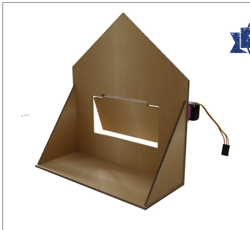
Com a estrutura pronta, vamos para a montagem da parte eletrônica do projeto, ela deve ficar conforme Figura 18, acoplada ao servomotor pela lateral.
