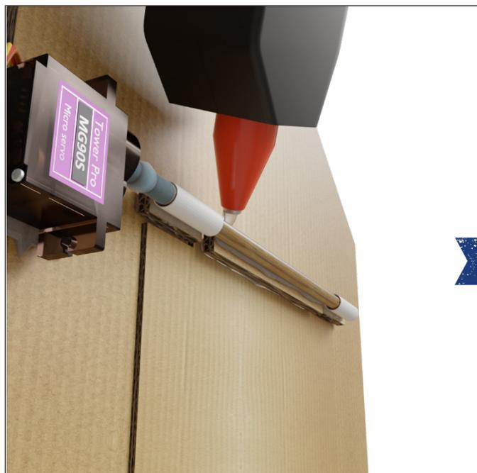
Figura 16 – Colagem do servomotor na parede
