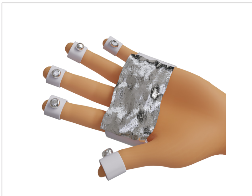
Figura 20 - Luva controladora finalizada na mão de um voluntário
