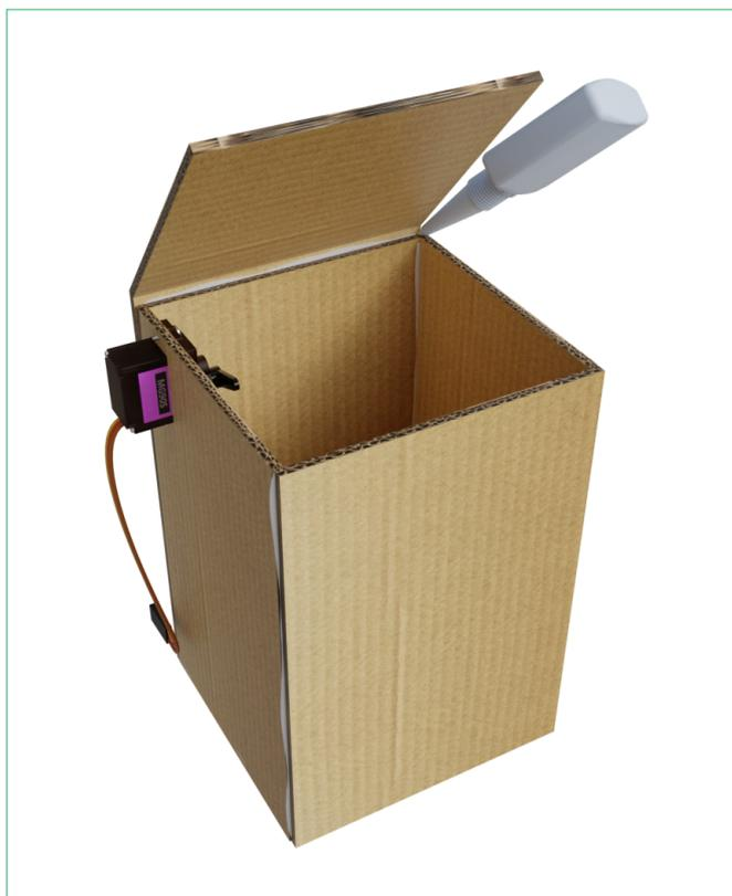
Figura 13 – Encaixe do palito na pá do servomotor
