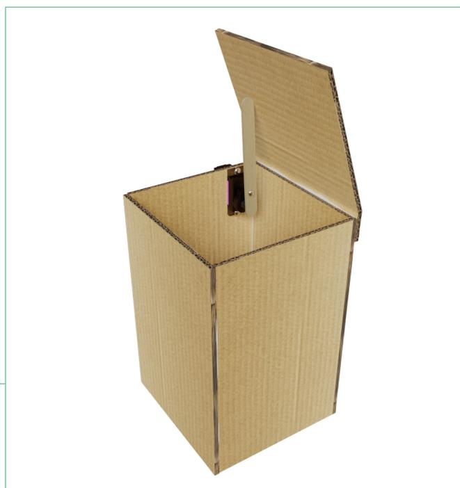
Pegue um palito de sorvete e fixe-o ao eixo do servomotor no lugar onde normalmente seria encaixada a pá. Utilize um parafuso pequeno para garantir a fixação. Dessa forma, quando o servomotor girar, o palito também girará, atuando como uma alavanca para abrir a tampa da lixeira.
