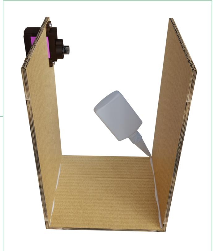
Figura 11 – Colagem da parte da frente
