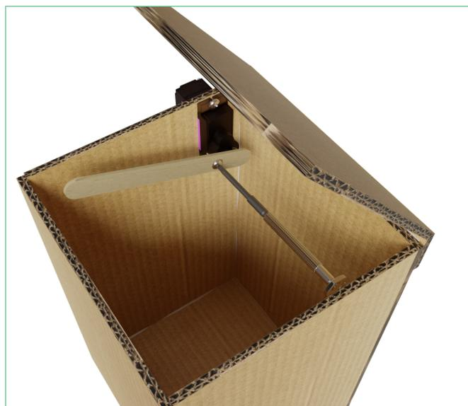
Figura 14 – Servo abrindo e fechando a caixa
