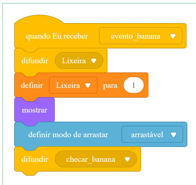
correspondente da tampa da lixeira, ela desaparecerá, se não, ela aparecerá e checará novamente. Assim, siga a sequência dos blocos. Quando o ator receber **<quando Eu receber "checar\_banana">** vai checar a posição da banana periodicamente, verificar se ela está tocando a cor preto **<a tocar a cor "definida**
