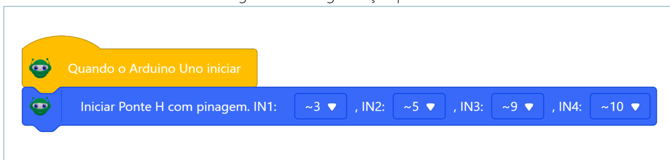
Figura 22 - Programação ponte H
