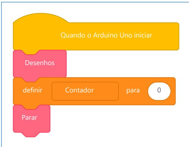
O primeiro bloco que colocamos ao inicializar o Arduino é chamar a função <Desenhos> e definir o contador para 0 <definir "Contador" para\_\_\_> (inicializando o elevador no térreo), em seguida, utilizamos o bloco que criamos <Parar> (para que o motor inicie parado).
