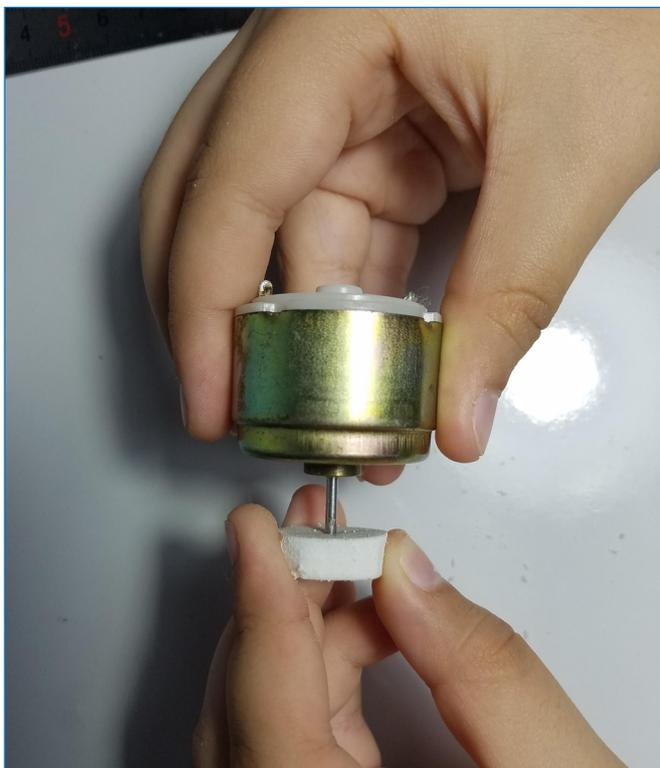
Figura 26 – Encaixe da borracha no eixo
