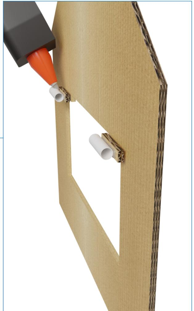
Figura 12 – Colagem da parte de cima da janela
