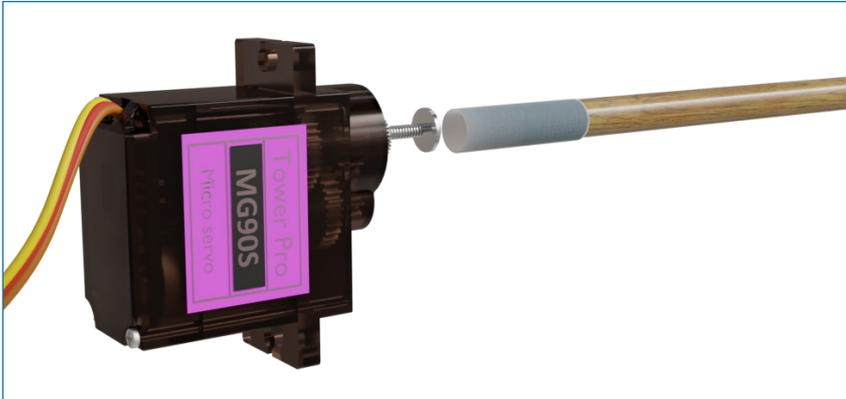
Corte um pedaço de canudo de plástico de aproximadamente 2 cm de comprimento. Encaixe o parafuso do servomotor em seu eixo, de modo a prolongá-lo.
