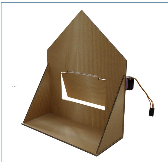
Usando cola quente, cole a base e as laterais de apoio para o protótipo, de forma que ele fique firme e não caia com o peso de abrir e fechar a janela.
