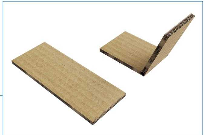
Cole essa peça em formato de "L" em cima da peça Z para formar o suporte do motor DC.
