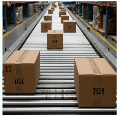
**Esteiras de roletes livres:** utilizadas principalmente para o transporte de insumos, consistem em rolos cilíndricos que permitem o movimento dos materiais por gravidade ou manualmente.
