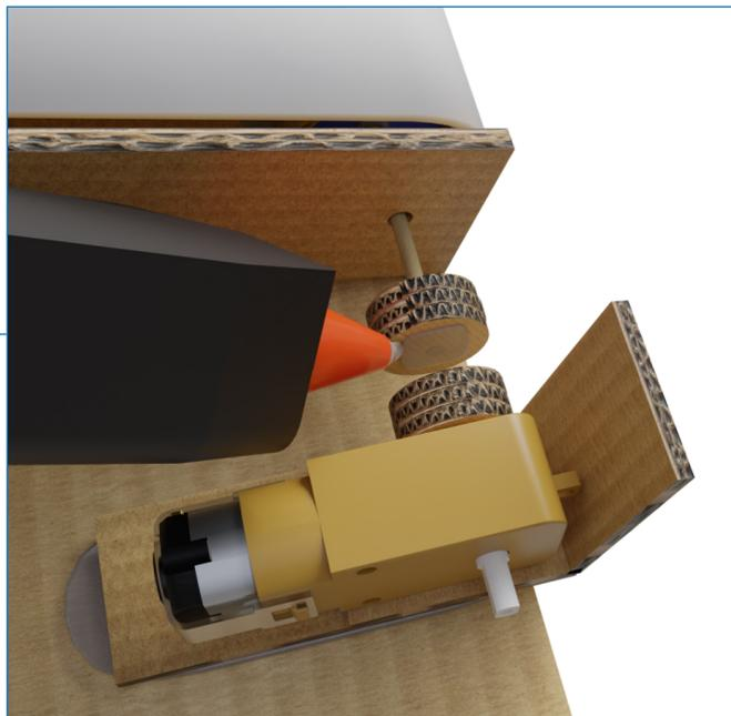
Figura 30 - Colagem da peça de suporte no motor DC
