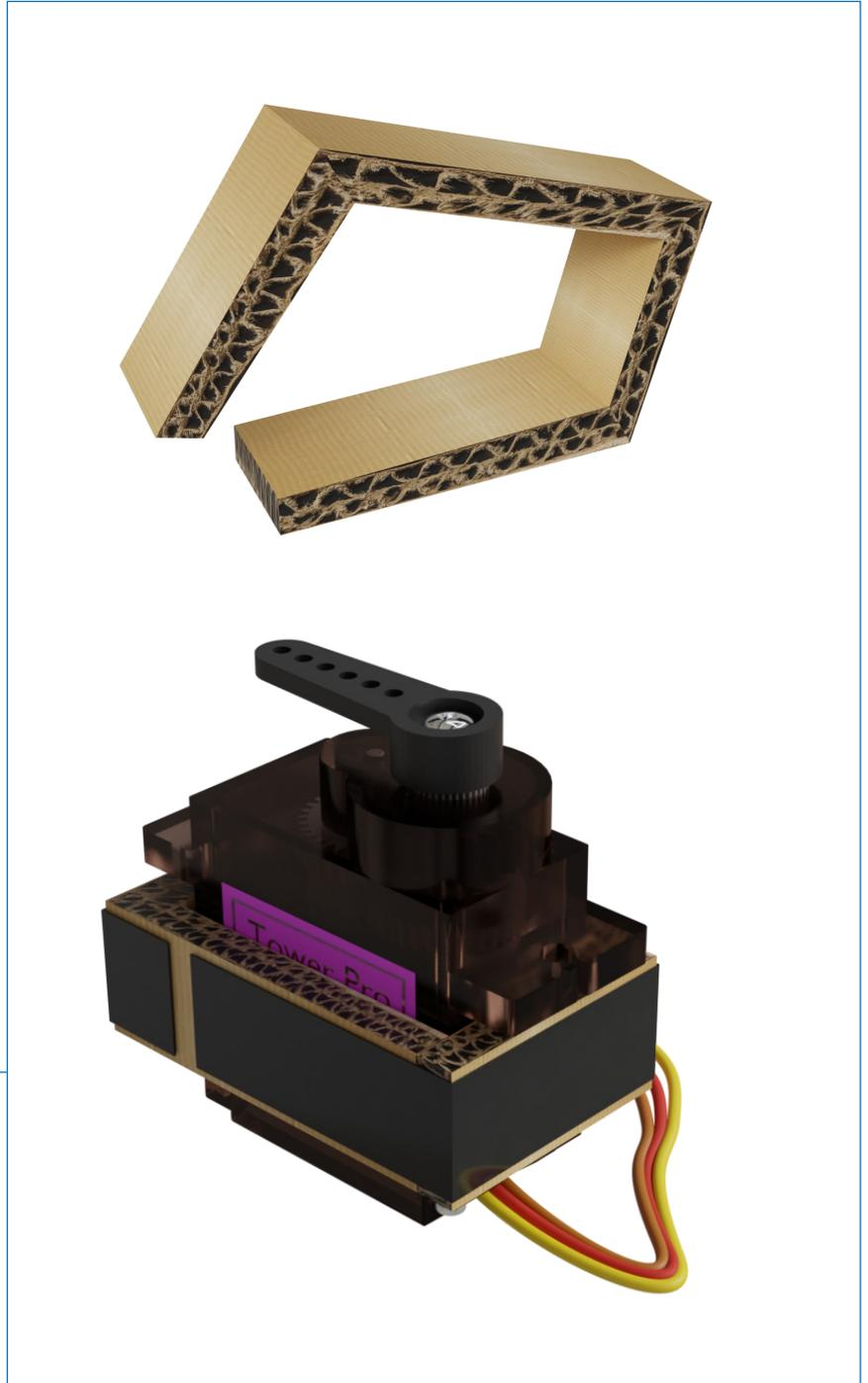
Aqueça a pistola de cola quente e posicione os servomotores sobre o papelão maior conforme a Figura 7, garantindo espaçamento uniforme e liberdade de movimento dos cabos. Aplique cola quente na base de cada servomotor, pressionando-os firmemente. Evite o excesso de cola e aguarde a secagem completa antes de prosseguir.
