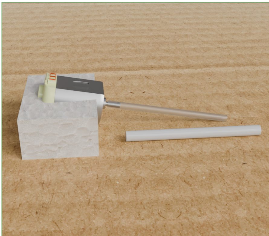
Figura 24 – Estrutura em isopor para motor do barco
