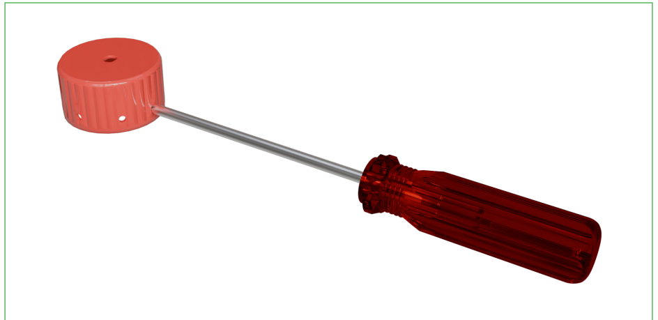
Figura 3 – Furação da lateral da tampinha
