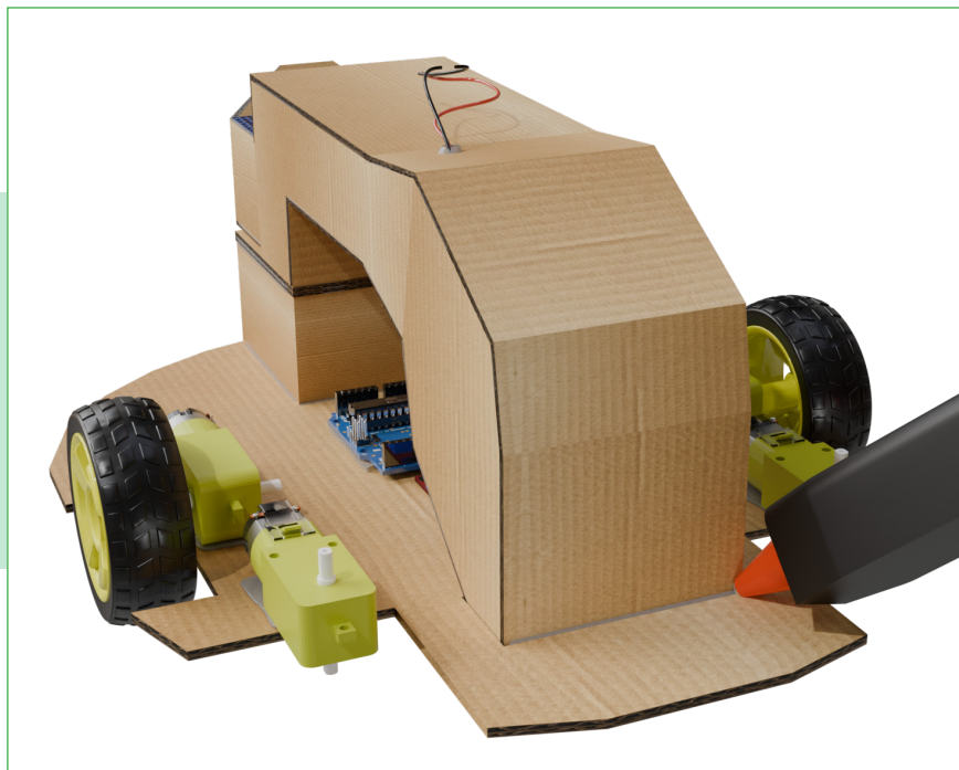
Figura 13 - Colagem final da estrutura central do robô-aspirador no chassi
