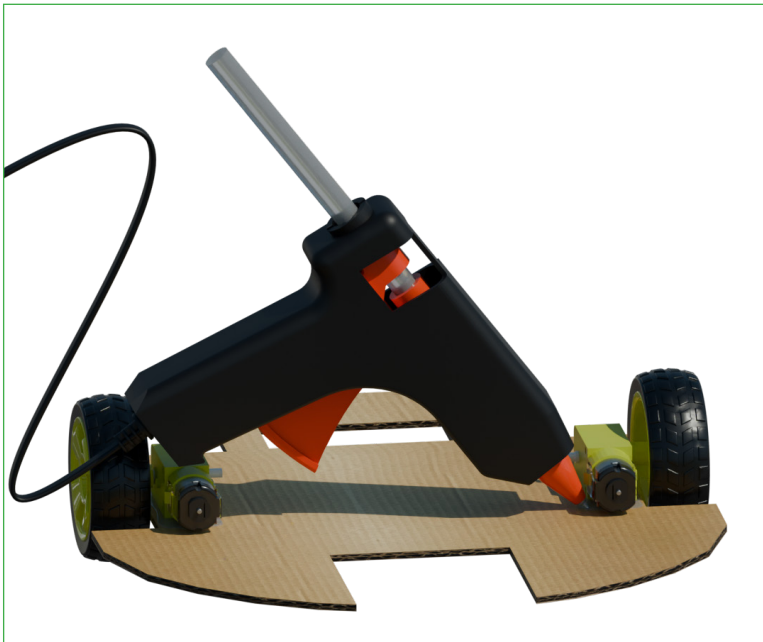
Figura 9 – Colagem do motor de redução com roda
