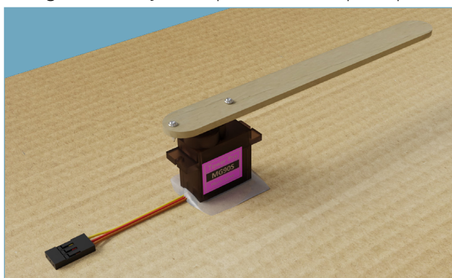
Figura 3: Adição do palito no eixo principal.
