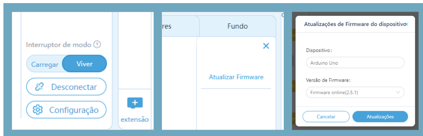
Figura 11 – Passo a passo para atualizar o Firmware.
