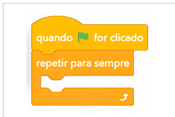
Figura 12: Inicialização da repetição do movimento uniforme do robô.
