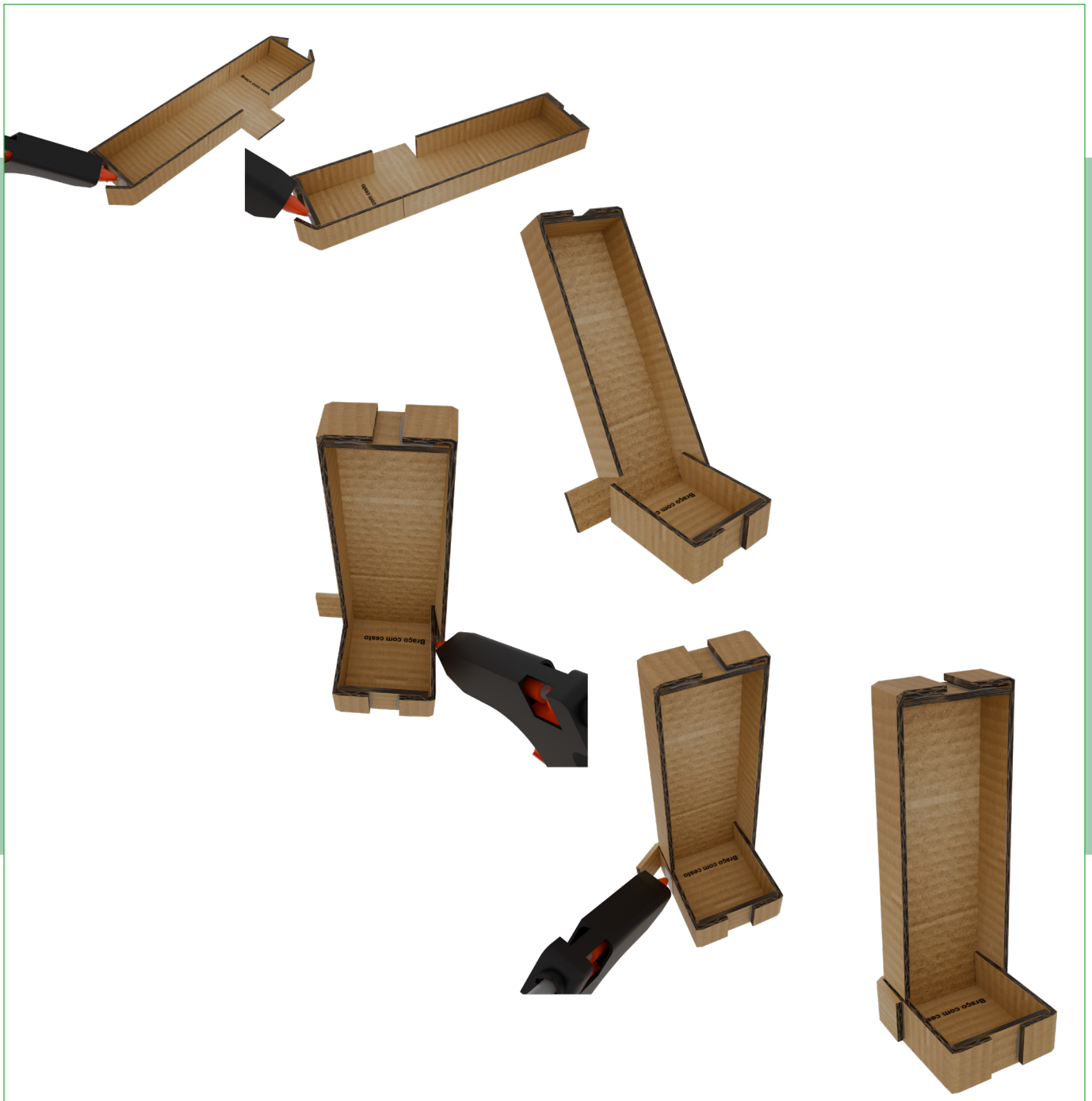
Figura 13 - Montagem braço com cesta II
